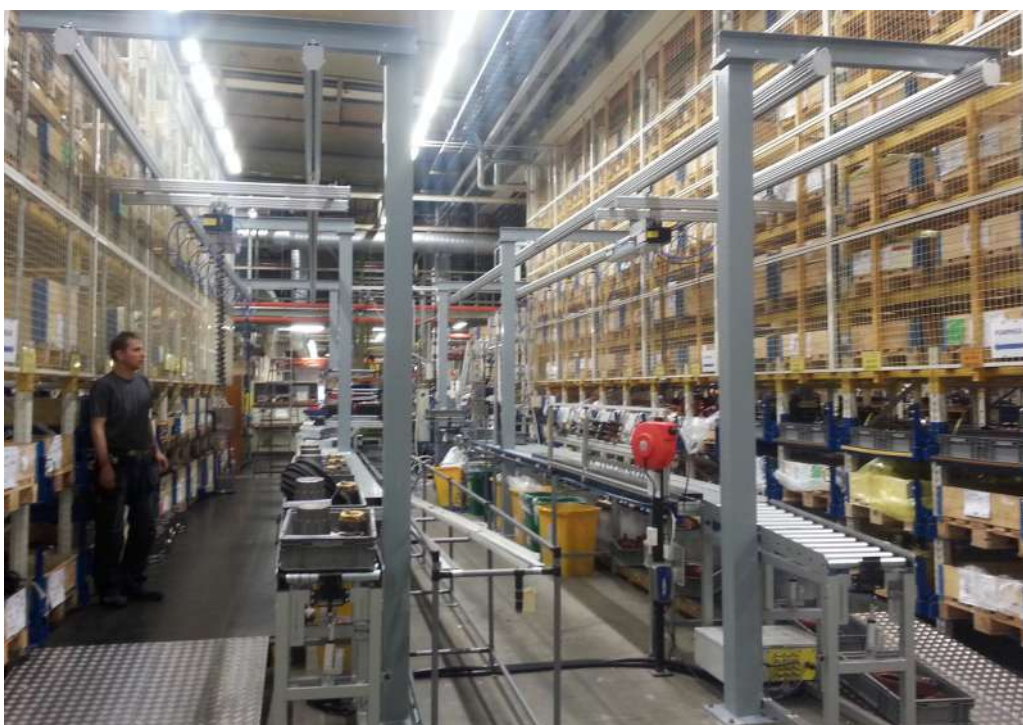
2st långa skensystem med små dubbeltraverser placerade i många stålgalgar.
