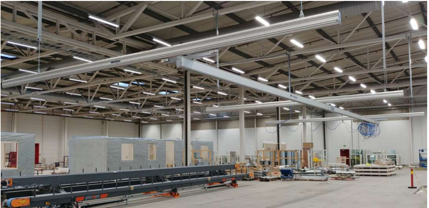
Skensystem med 3st banbalkar och en lång traversbalk samt långa pendlar från takbalkarna.
